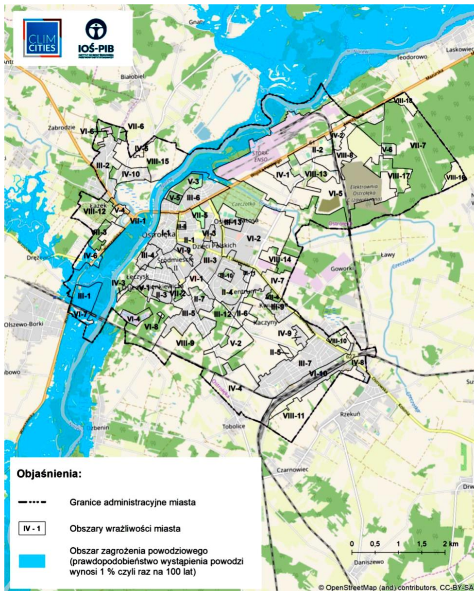
Rysunek 20 Mapa obszarów zagrożenia powodziowego prawdopodobieństwo wystąpienia powodzi 1% czyli raz na 100 lat
