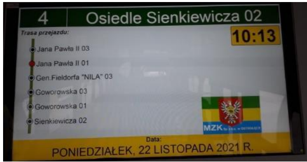
Rysunek 74 Tablica kierunkowa z identyfikacją przystanków na linii zainstalowana wewnątrz autobusu MZK Ostrołęka
