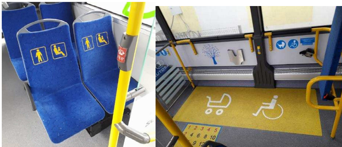
Rysunek 67 Oznakowanie miejsc dla osób z ograniczeniami ruchowymi w autobusie MZK Ostrołęka
