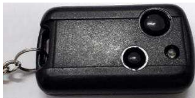
Rysunek 72 Piloty służące do identyfikacji autobusów przez osoby niedowidzące
