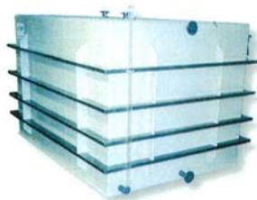
Zbiornik przelewowy (wyrównawczy) spawany z płyt PP
