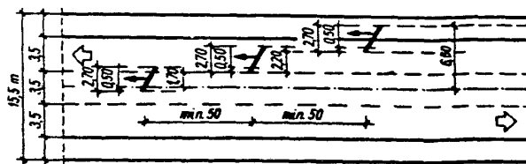
Rys. 4. Schemat pracy zespołu czterech pługów na drodze czteropasowej dwukierunkowej
